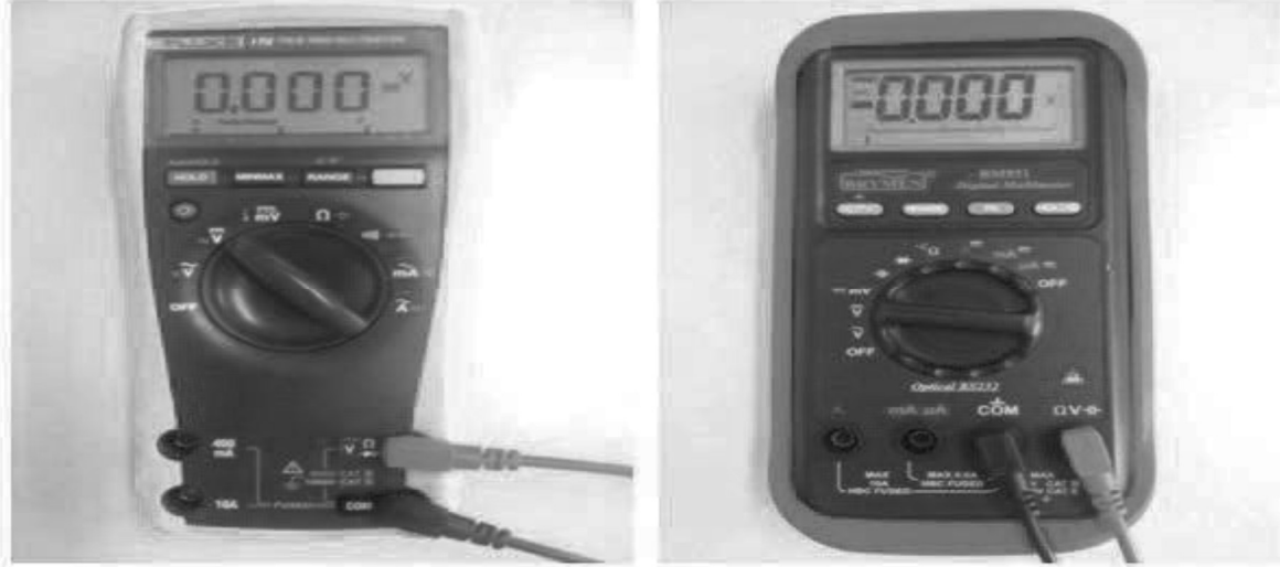
Şekil.9 DC volt ölçümü için hazırlanmış multimetreler
